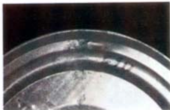
RETAK DI PENUTUP
